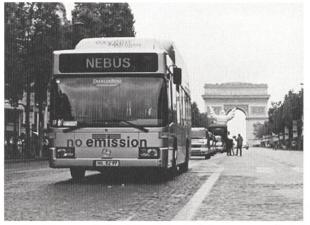
Autobus mit Brennstoffzellen (Bild DaimlerChrysler).
