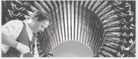
Hochspannungs-Elektromotor «Motorformer» (Stator; Bild ABB).
