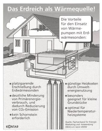
Die Vorteile von Wärmepumpen mit Erdsonden (Bild Kontar).
