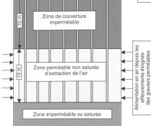
Figure 1 Disposition des puits de captage pour une villa, puissance 8,5 kW (coupe schématique d'un groupe de puits). Les puits sont reliées entre eux. Ils traversent la couverture imperméable avant d'atteindre la zone de gravier perméable exploitable.
