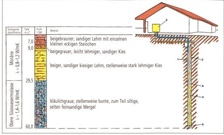
Bild 1 Erdsondenprinzip und geologische Situation.
