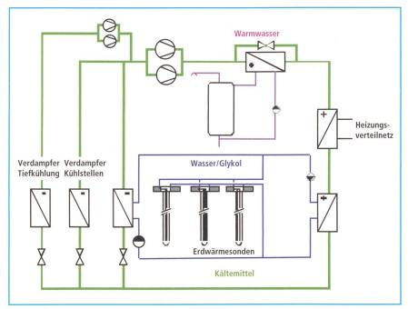
Bild 2 Vereinfachtes Fliessbild einer von der Firma KWT für ein Restaurant ausgeführten Anlage zur gekoppelten Kälte- und Wärmeproduktion mit direkter Verdampfung und kleinem Erdwärmesondenfeld.
