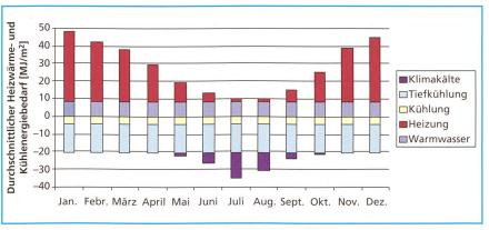
Bild 1 Gemessene Monatsmittelwerte des Heiz- und Kühlenergiebedarfs in einem Restaurant.
