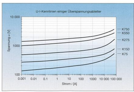
Bild 1 Kennlinien einiger Varistoren, welche als Überspannungsableiter für Stossströme bis 70 kA (8  $\mu$ s/20  $\mu$ s) eingesetzt werden können.
