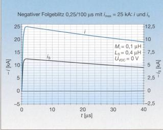
Bild 7 In einer relativ kleinen Schleife mit  $M_i = 0.1 \,\mu\text{H}$  und  $L_S = 0.4 \,\mu\text{H}$  (ohne Varistor) von einem negativen Folgeblitz mit  $i_{max}$  = 25 kA induzierter Kurzschluss-
