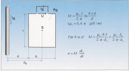
Bild 2 Gegeninduktivität zwischen einer (Teil-)Blitzstrom führenden Ableitung und einer rechteckigen Leiterschleife der Länge / im Abstand d von der Achse der Ableitung
