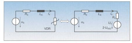
Bild 3 Ersatzschaltung zur Berechnung der auftretenden Varistorströme  $i_V$  in mit einem Blitzstrom induktiv gekoppelten Schleifen (links Originalschaltung, rechts linearisierte Form für den Fall  $i_V > 0$ )  $u_S = M \cdot \mathrm{d}i_A/\mathrm{d}t = M_i \cdot \mathrm{d}i/\mathrm{d}t$
