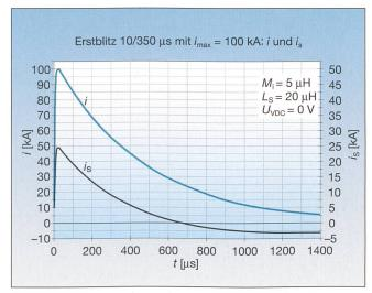
Bild 4 In einer relativ grossen Schleife mit  $M_i$  = 5 μH und  $L_S$  = 20 μH (ohne Varistor) von einem Erstblitz mit  $i_{max}$  = 100 kA induzierter Kurzschlussstrom  $i_S$
