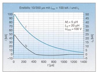
Bild 5 In der gleichen wie in Bild 4 verwendeten Schleife mit einem Varistor mit einer relativ kleinen maximalen DC-Betriebsspannung  $U_{\rm VDC}$  = 100 V von einem Erstblitz mit  $i_{\rm max}$  = 100 kA induzierter Strom  $i_{\rm S} = i_{\rm V}$
