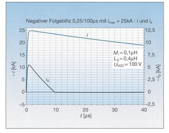
Bild 8 In der gleichen wie in Bild 7 verwendeten Schleife mit einem Varistor mit einer relativ kleinen maximalen DC-Betriebsspannung  $U_{\rm VDC}=100~{\rm V}$  von einem negativen Folgeblitz mit  $i_{\rm max}=25~{\rm kA}$  induzierter Strom  $i_{\rm S}=i_{\rm V}$ .
