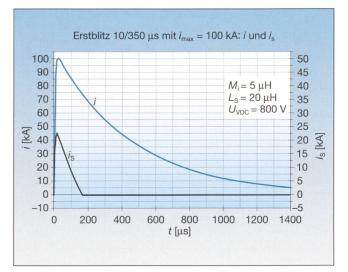
Bild 6 In der gleichen wie in Bild 4 verwendeten Schleife mit einem Varistor mit einer relativ grossen maximalen DC-Betriebsspannung  $U_{VDC}$  = 800 V von einem Erstblitz mit  $i_{max}$  = 100 kA induzierter Strom  $i_{S} = i_{V}$
