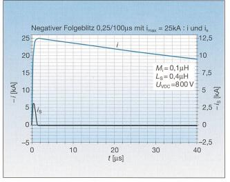
Bild 9 In der gleichen wie in Bild 7 verwendeten Schleife mit einem Varistor mit einer relativ grossen maximalen DC-Betriebsspannung  $U_{\rm VDC} = 800$  V von einem negativen Folgeblitz mit  $i_{\rm max} = 25$  kA induzierter Strom  $i_{\rm S} = i_{\rm V}$ .
