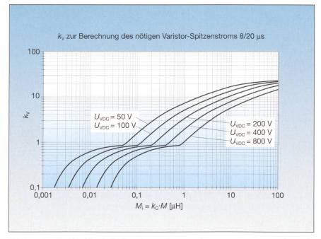
Bild 10 Varistor-Korrekturfaktor k<sub>V</sub> für die Bestimmung des notwendigen Varistorstroms I<sub>V8/20</sub> aus dem maximalen Kurzschlussstrom der verlustlosen Schleife mit (17)
