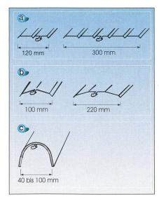
Bild 2 Formgebung und Wanddicke von Warneinrichtungen mit mechanischer Schutzwirkung a: Plattenprofil, b: Sattelprofil, c: Rundprofil
