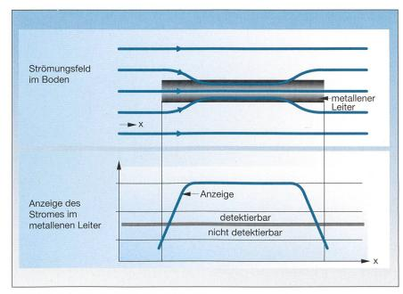
Bild 7 Metallener Leiter im Erdboden: Detektierbarkeit
