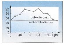
Bild 10 Ortbarkeit eines Trassenbandes mit Cu-Draht (Messwerte)
