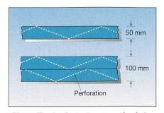
Bild 1 Sollbruchstellen in einem Trassenband mit visueller Warnwirkung, Kelmaplast (EN 12613)
