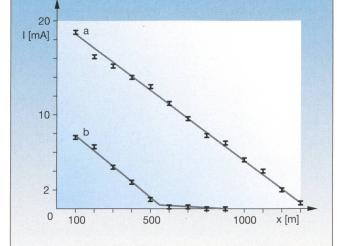
Bild 9 Aktive Ortung: Stromstärke entlang eines Trassenbandes mit Unterbrechung des Leiters (b)
