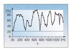
Bild 12 Passive Ortung: Ortungssignalpegel einer Trasse
