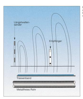
Bild 6 Passive Ortung eines Trassenbandes mit Hilfe eines Längstwellensenders
