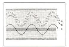
Bild 3 Detektierbares Trassenband (Prinzip) a, b: isolierte Leiter, c: blanker (erdfühliger) Leiter
