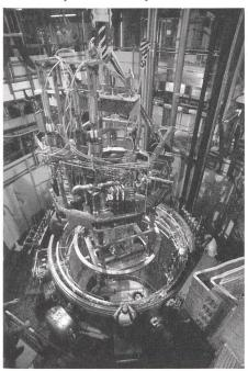
siert werden. Der Strom von 80 000 Ampere wurde mehrmals reproduzierbar angefahren; die Spule hat den Test erfolgreich bestanden. Damit steht die komplexe Spulentechnologie für zukünftigen die Projekte in der Kernfusion zur Verfügung.
