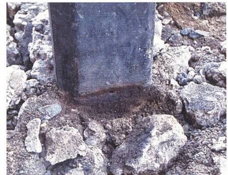
Bild 2 Freigelegter Korrosionsangriff im Erdeintrittsbereich.
