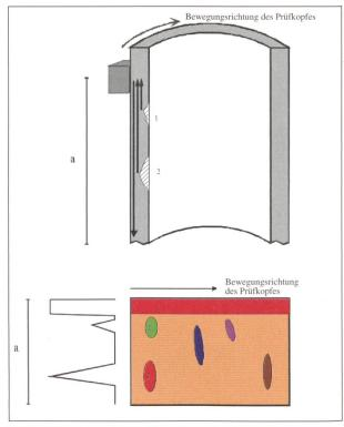
Bild 4 Prüfverfahren (schematische Darstellung).
