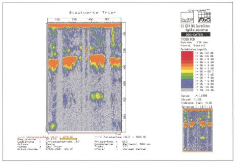
Bild 5 Prüfbefund mit Korrosionsstelle (Ultraschall B-Bild).
