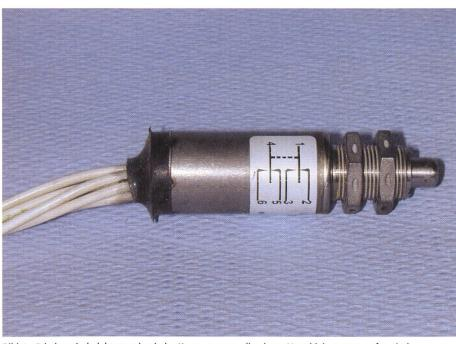
Bild 1 Schalter sind elektromechanische Komponenten, die einem Verschleiss unterworfen sind.
