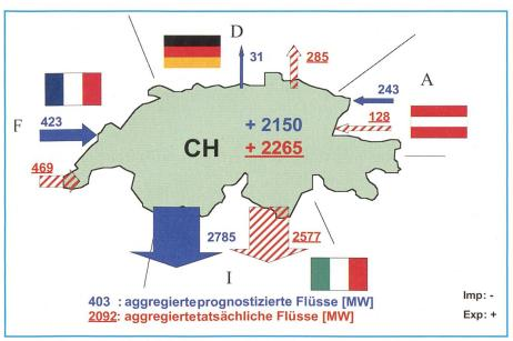
Bild 4 Lastflussprognose für den 14.2.2001/10:30 Uhr – aggregierte prognostizierte und tatsächliche Flüsse [MW]. Der grösste Prognosefehler wurde durch eine Produktion, welche wegen einer Störung um 180 MW kleiner als geplant ausfiel, verursacht.
