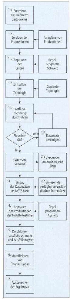
Bild 2 Verfahren der täglichen Lastflussprognose.
