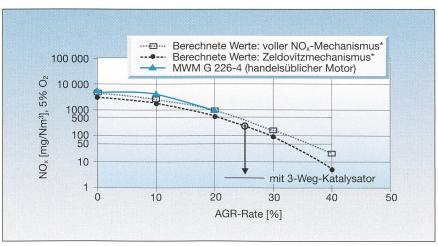
Bild 1 NO<sub>x</sub>-Emissionen in Abhängigkeit der AGR-Rate, jeweils für zwei verschiedene Berechnungsarten und für ein handelsübliches Aggregat (Motortyp: MWM G226-4). \* = standardisiertes Berechnungsverfahren
