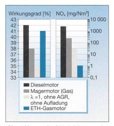
Bild 4 Wirkungsgrad und NO<sub>x</sub>-Emissionen von vier Motorkonzepten
