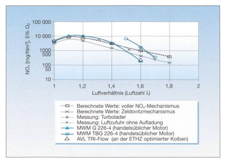
Bild 2  $NO_x$ -Ausstoss in Abhängigkeit des Luftverhältnisses  $\lambda$  für verschiedene Konzepte mit abgemagertem Treibstoffgemisch. Mehrere Konzepte stossen bei einem  $\lambda$  von 1,6 und 1,7 in den von der LRV tolerierten Bereich von rund 250 mg/Nm³ vor. Die gerechneten Werte sind bis auf  $\lambda$  = 1,8 extrapoliert. (Quelle: ETH)
