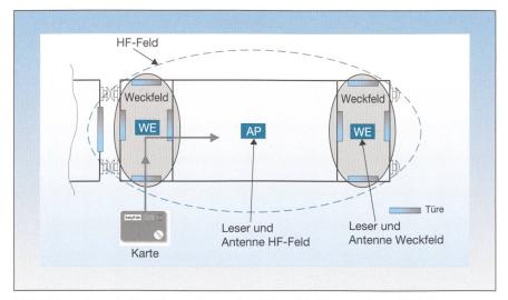
Bild 4 Prinzipschema der Bibo-Erfassung Test Basel: Aufsicht auf ein Fahrzeug; als Beispiel ein Eisenbahnwagen
