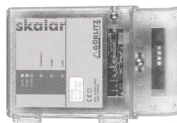
Kommunikationscomputer zur Energiedatenübertragung im Internet.
