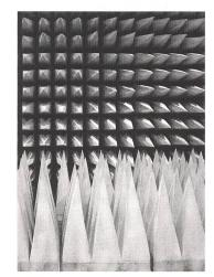
EMV-Messungen werden grundsätzlich in geschirmten, mit Hochfrequenz (HF)-Absorbern ausgekleideten Messräumen durchgeführt. Das Foto zeigt einen Ausschnitt aus den typischen Wand-, Boden und Deckenverkleidungen aus Schaumstoff
