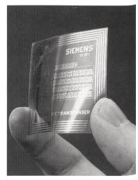
Integrierte Schaltkreise aus Polymeren.
