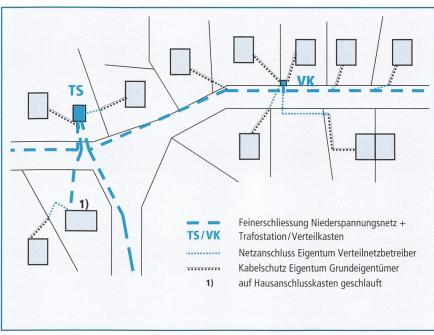
Bild 1 Technische Abgrenzung im lokalen Verteilnetz innerhalb der Bauzone.
