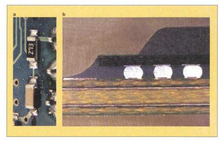
Bild 2 Starre Verbindung bedeutet hohen Stress bei SMD-Technologie
