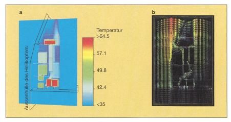
Bild 7 Temperaturverteilung und Luftströmung im Schaltschrank
