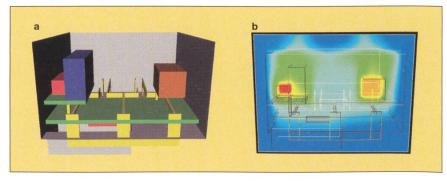
Bild 6 Thermische Simulation eines Leistungsschalters
