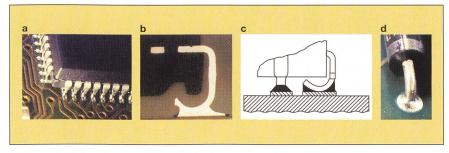
Bild 1 Mechanische Federung zum Ausgleich der thermischen Ausdehnung
