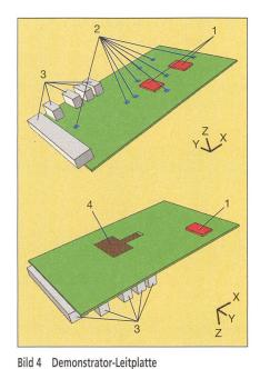
1: BGA (IC<sub>1</sub> und IC<sub>2</sub> auf der Oberseite, IC<sub>3</sub> auf der Unterseite); 2: Temperatursonden, 3: Stecker; 4:
