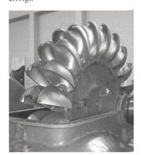
Peltonturbinen-Laufrad (Bild VA TECH Hydro).
