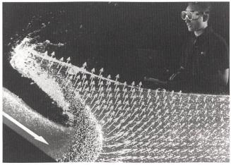
Digitale Aufzeichnung einer Flutwelle im Rutschgenerator der Versuchsanstalt für Wasserbau, Hydrologie und Glaziologie der ETH Zürich. Mit Hilfe reflektierender Kunststoff-Kügelchen werden die Wasserbewegungen beobachtet. Die Pfeile geben die Kräfteverteilung wieder.
