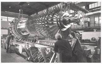
150-MW-Gasturbine für GuD-Anlage (Bild Siemens).
