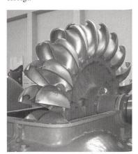
Peltonturbinen-Laufrad (Bild VA TECH Hydro).
