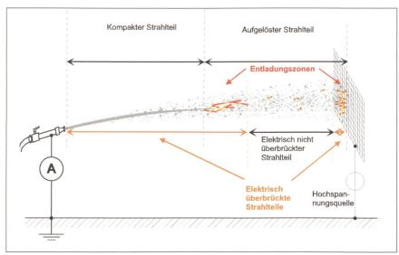
Bild 2 Elektrisches Modell eines zerfallenden Löschstrahls auf ein unter Spannung stehendes Anlagenteil bei ausreichendem Spritzabstand. Bei einer Vereinigung der Entladungszonen resultiert ein lebensgefährlicher Ableitstrom.
