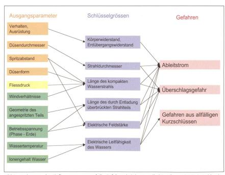
Bild 3 Verkettung der Einflussparameter auf die Gefahren bei der Brandbekämpfung mit Löschstrahlen in elektrischen Anlagen: braun: Einflussgrössen von Material, Personal; gelb: Betriebseinflussparameter; grün: Umweltparameter, blau: physikalische Schlüsselgrössen; rot: Gefahren.
