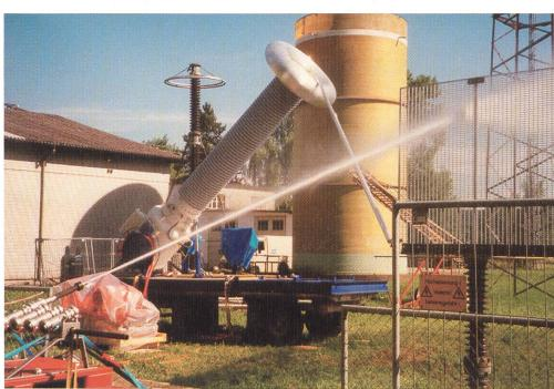
Bild 1 Versuchsaufbau in der FKH-Versuchsstation in Däniken: Im Vordergrund links: isolierte Konsole mit diversen Strahlrohren, rechts: Prallgitter unter Hochspannung, im Hintergrund: Mobiler Prüftransformator 510 kV.
