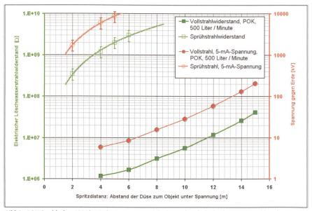
Bild 6 POK-Strahlrohre 500 Liter/Minute, Typen: Debikador und Turbokador bei Sprühstrahl und Vollstrahl: Strahlwiderstand und Elekroden-Spannung für einen Ableitstrom von 5 mA.
