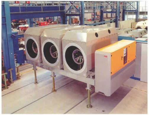
Bild 1 Generatorschaltersystem HEC 7/8 in der Endmontage.
