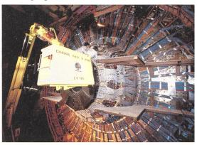
Titelbild: «Power» in der Forschung: Das bei Genf gelegene CERN (Europäische Organisation für die nukleare Forschung) ist eines der renommiertesten Forschungszentren der Welt. Das Bild zeigt Arbeiten am Detektor Delphi, ein Experiment im LEP (Large Electron-Positron collider). Der «LEP» ist der weltgrösste Teilchenbeschleuniger. In einem Ring von 27 km Durchmesser, 100 m unter der Erde, werden Pakete von Elektronen und Positronen bis zu Lichtgeschwindigkeit beschleunigt (Foto CERN/P. Loiez).
