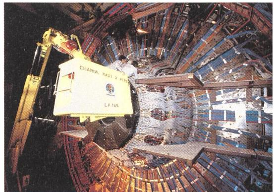
**Titelbild:** «Power» in der Forschung: Das bei Genf gelegene CERN (Europäische Organisation für die nukleare Forschung) ist eines der renommiertesten Forschungszentren der Welt. Das Bild zeigt Arbeiten am Detektor Delphi, ein Experiment im LEP (Large Electron-Positron collider). Der «LEP» ist der weltgrößte Teilchenbeschleuniger. In einem Ring von 27 km Durchmesser, 100 m unter der Erde, werden Pakete von Elektronen und Positronen bis zu Lichtgeschwindigkeit beschleunigt (Foto CERN/P. Loiez).
