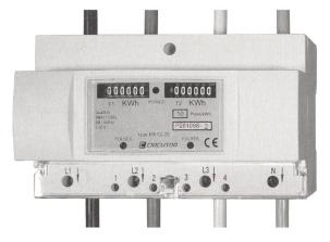
True RMS - 2-Quadrantmessung - mit potentialfreiem Impulsausgang. Ausführungen direktmessend bis 120A und für Stromwandler x/5A (Primärströme 5 bis 7500 wählbar)
