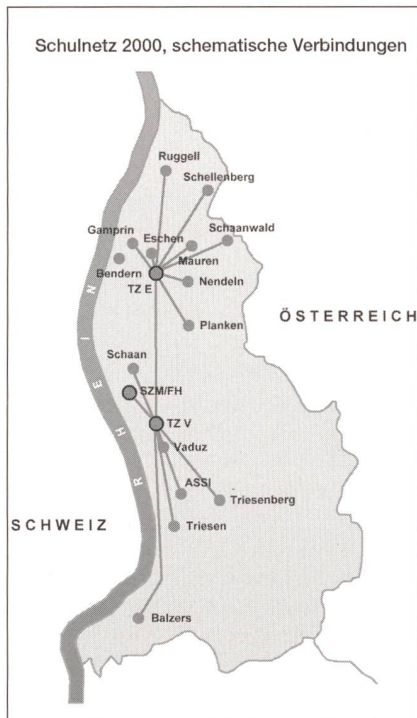
Bild 2 Geografische Situation des Schulnetzes 2000 SZM/FH = Schulzentrum Mühleholz/Fachhochschule Liechtenstein Assi = Arbeitsstelle Schulinformatik TZ E = Telefonzentrale Eschen TZ V = Telefonzentrale Vaduz Die dargestellten geraden Linien bezeichnen die 1000-Mbps-Verbindungen
