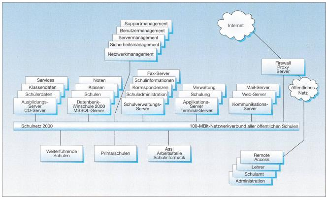
Bild 3 Schematische Darstellung des Schulnetzes 2000
