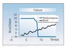
Fig. 4 La rapidité d'un canal de communication tombe brusquement sous l'effet d'un code de détection/correction d'erreurs poussé au-delà de ses limites.
