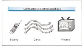
Fig. 1 Définitions fondamentales concernant la compatibilité électromagnétique (CEM).
