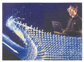
Digitale Aufzeichnung einer Flutwelle im Rutschgenerator. Mit Hilfe reflektierender Kunststoffkügelchen werden die Wasserbewegungen beobachtet. Die Pfeile geben die Kräfteverteilung wieder.
