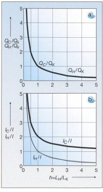
Bild 3 Verhältnisse der Blindleistungen und Ströme bei vollständiger Kompensation als Funktion des Induktionsverhältnisses  $h=L_H/L_{\rm Ki}$
