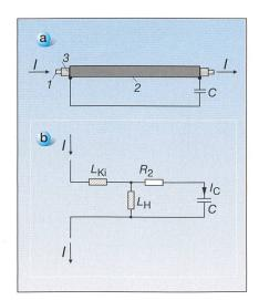
Bild 1 Kabelader mit Kompensationskapazität im Mantelkreis
