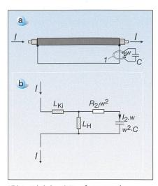
Bild 4 Kabelader mit Transformator und Kompensationskapazität im Mantelkreis
