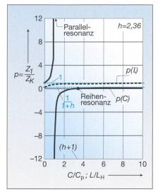
Bild 2 Resultierende Längsimpedanz
