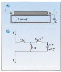
Bild 5 Kabelader mit parallelem, mehradrigem Kabel
