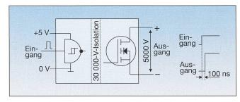
Bild 2 Speisung der Hochspannungsseite
