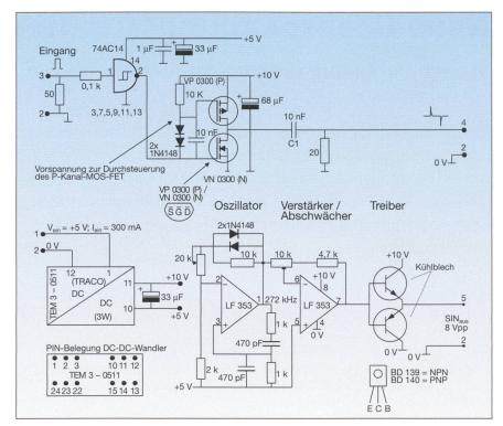
Bild 4 Detailschema Kleinspannungsseite
