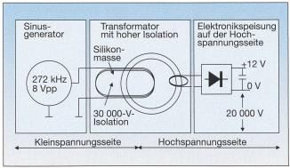
Bild 3 Blockschaltbild für Ein/Aus-Schalter
