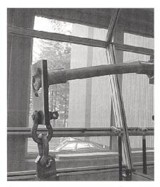
Bild 10 Bruchverhalten des Stützers
