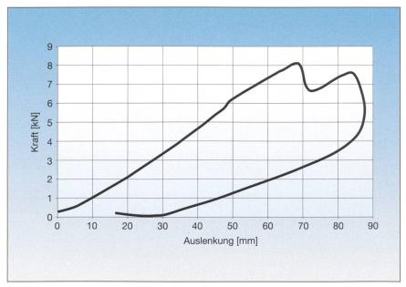
Bild 12 Restfestigkeit des gebrochenen Stützers nach 96-h-Test
