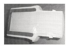
Bild 9 Schadensbild des SCL-geprüften Stützers
