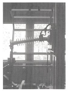
Bild 8 SCL-Versuch des 72,5-kV-Stützers
