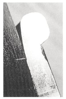
Bild 7 Schadensbild bei Überschreiten des MDCL-Wertes
