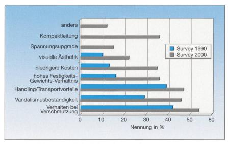
Bild 6 Gründe für den Einsatz von Verbundisolatoren laut Cigré-Befragung
