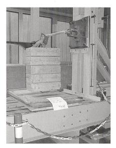
Bild 11 96-h-Test des gebrochenen Stützers
