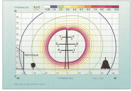
Bild 1 220-kV-Leitung mit nicht idealer (nicht punktsymmetrischer) Anordnung der Leiter (berechnet) Das Wohnhaus liegt im Grenzwertbereich von 1 u.T. Die Kreise definieren Orte mit identischer magnetischer
