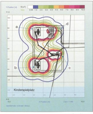
Bild 3 (links): Trafostation vor dem Umbau. Zwei Trafos (a, b) mit je einer Leistung von 630 kVA sind in Betrieb (I<sub>N sek</sub> = 909 A). c = Niederspannungsverteilung, d = Mittelspannungsinstallation – Bild 4 (rechts): Trafostation nach dem Umbau. Zwei Trafos (a, b) mit je einer Leistung von 630 kVA sind in Betrieb (I<sub>N sek</sub> = 909 A), die Niederspannungsverteilung (c) ist jetzt an einer Zwischenwand montiert. d = Mittelspannungsinstallation
