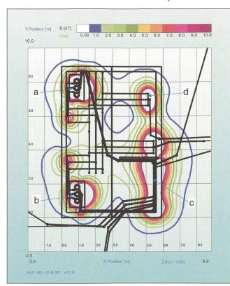
Bild 6 Ursprüngliche Anordnung der Komponenten
