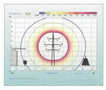
Bild 2 Gleiche Berechnung wie Bild 1, aber mit punktsymmetrischer Anordnung der Leiter
