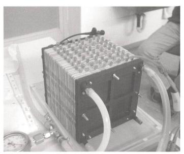
Direkt-Methanol-Brennstoffzelle mit 500 W Leistung.
