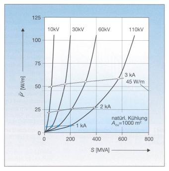
Bild 3 (links) Verlustleistungsbeläge natürlich gekühlter Sechsleiterkabel (3·6·1000 mm²) bei dauernd anstehender Volllast als Funktion der Übertragungsleistung; Parameter: Betriebsspannung
