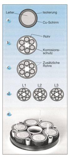
Bild 1 Durch Verseilung von sechs Einzeladern gebildetes Sechsleiterkabel
