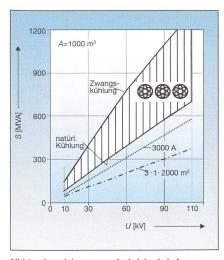
Bild 2 Grenzleistung von Sechsleiterkabeln (3-6-1000 mm²) als Funktion der Betriebsspannung (s. Text)
