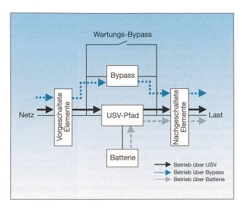
Bild 1 Prinzipieller Aufbau einer USV-Anlage
