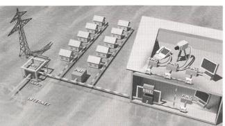
Powerline-Prinzip mit Ortnetztrafo, Repeater und Hausanschluss.
