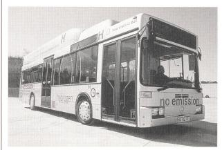
Brennstoffzellen-Autobus von DaimlerChrysler.
