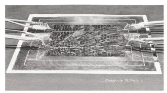
Vermessung einer Photovoltaikzelle.
