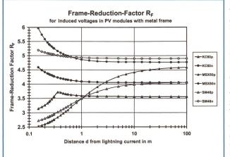
Bild 7 Rahmen-Reduktionsfaktor R<sub>F</sub> in Funktion des Abstandes vom Blitzstrom bei drei verschiedenen Modultypen: Additives Modul KC60: 4-reihiges kompensierendes Modul MSX60; 3-reihiges kompensierendes Modul SM46 (letzter Buchstabe: p = Parallel-, n = Normalposition). Bei allen Modulen zeigt sich das gleiche Verhalten, das heisst, ein Rahmen reduziert die induzierte Spannung beträchtlich. Für grössere Distanzen wurden die Werte mit einem Rechenmodell ermittelt.
