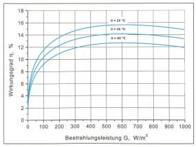
Bild 3 Wirkungsgrad  $\eta$  des Siemens-Moduls SM110 in Funktion der Bestrahlungsleistung G und der Zellentemperatur  $\vartheta$  (Beachte:  $\eta$  bezieht sich auf die aktive Zellenfläche, 0,72 m²).
