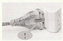
Durch die Verwendung zweipoliger Kabel wurde die Schutztrennung mit isoliertem Potentialausgleich ausser Funktion gesetzt.
