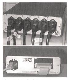
Bild 4 Schaltbox mit sechs Relaisausgängen
