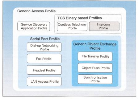
Bild 2 Die Familie der Anwendungsprofile nach der Bluetooth-Spezifikation 1.1
