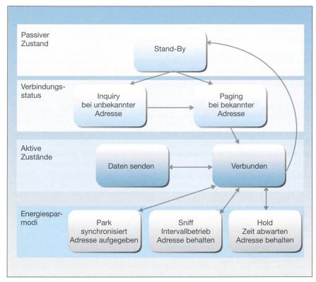
Bild 3 Die Betriebszustände eines Bluetooth-Moduls
