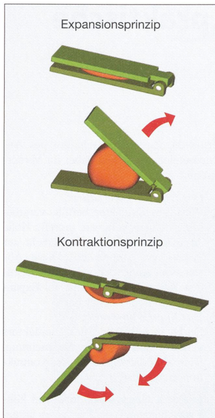
Bild 3 Schematische Gestaltung von Gelenken nach dem Kontraktions- bzw. dem Expansionsprinzip
