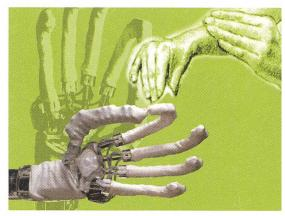
Pneumatische und hydraulische Aktoren wie sie etwa in der Industrie eingesetzt werden, halten nun auch in medizintechnischen Geräten Einzug. Neue kompakte Bauformen in Kombination mit elastischen Oberflächenmaterialien lassen grosse Freiheitsgrade bei der Bewegung der Finger und des Handgelenks von Prothesen zu und ermöglichen so einen natürlich wirkenden Bewegungsablauf mit gleichzeitiger Reduktion des unnatürlichen Härtegefühls beim Händedruck.
