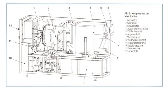
dichter fördert Verbrennungsluft in die Brennkammer, in der zur kontinuierlichen Verbrennung Brennstoff beigemischt wird. Der Heissgasstrom expandiert in der Turbine. Sie wandelt einen Grossteil der Wärmeenergie in mechanische Energie um, die den Verdichter und die Last antreibt. Im Gegensatz zu konventionellen Kraftwerken ist bei der Mikroturbine ABB MT100 der hochtourige Generator direkt mit der Turbinenwelle gekuppelt, und ein Umrichter passt die Drehzahl elektronisch an.
