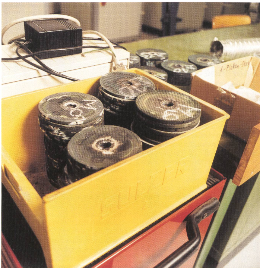
Komponenten des Zellenstapels nach Langzeitbetrieb.
