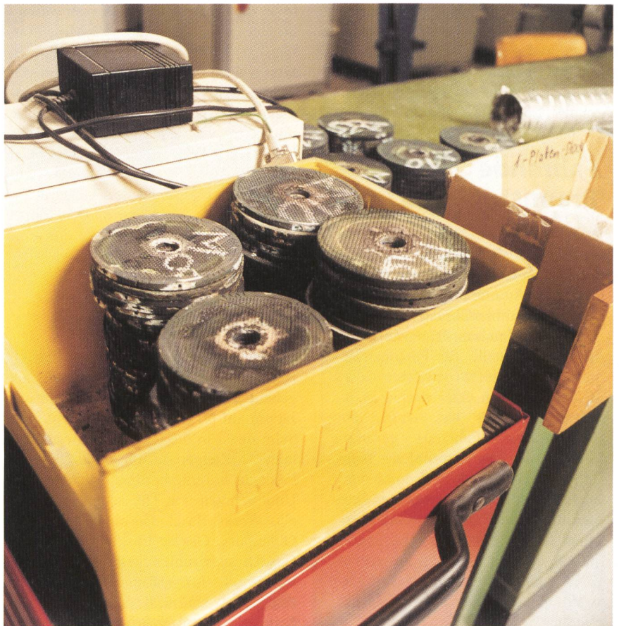
Komponenten des Zellenstapels nach Langzeitbetrieb.
