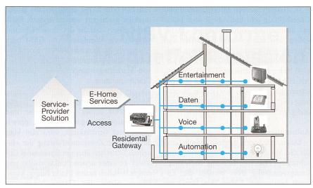
Bild 1 Die Bestandteile des Electronic Home (Bild: Stoll)
