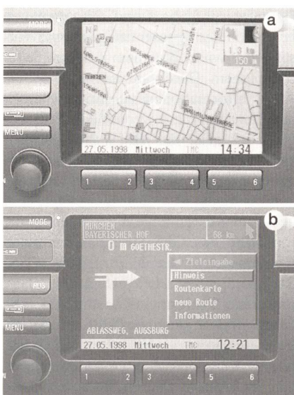
Bild 3 Strassenkarte mit Routenempfehlung (a) sowie die alternative Zielführung mittels Zielführungsdiagramm (b) Beide Darstellungsformen werden durch eine Sprachausgabe unterstützt.
