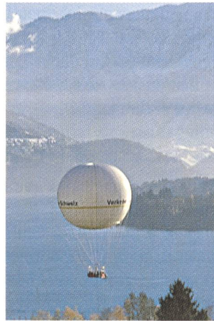
Fesselballon Hiflyer im Verkehrshaus. Ballon: Höhe 36 m, Gewicht 3,6 t, Durchmesser 22m, Füllung 5000 m 3 . Korb: 25–30 Passagiere, Gewicht 1 t. Flughöhe 120 m, Auftriebskraft 6 t (Quelle: Verkehrshaus Luzern)
