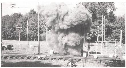
Praktische Versuche für die Entwicklung von Schutzbekleidung. Vaporisation du cuivre et projections de métal en fusion.
