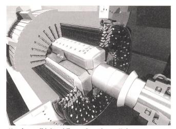
«Motorformer» (Schnittmodell): neue Generation von Hochspannungsmotoren.
