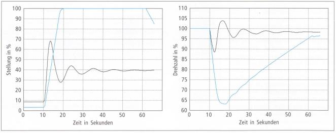
Bild 3 Stellung der Peltondüse bzw. des Leitapparates und Drehzahl bei einem Lastsprung von 0% auf 40% bei einer Peltonturbine und einer Francisturbine.
