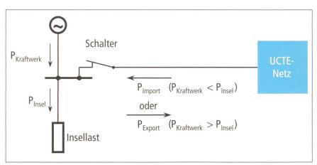
Bild 1 Prinzipschaltbild der Messanordnung. Durch Öffnen des Schalters wird der unstete Übergang realisiert.
