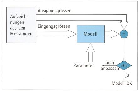
Bild 2 Prinzip der Identifikation.
