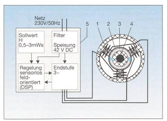
Bild 5 Funktionsprinzip des sensorlosen Elektronikmotors: 1 = Stator mit Wicklungen; 2 = Spaltrohr, innerhalb: Wasser; 3 = Magnetring; 4 = Welle; 5 = Elektronik
