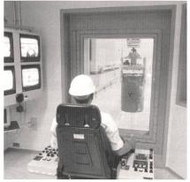
Der Kranführer beschickt das Lager mittels Fernbedienung in einem geschützten Nebenraum.
